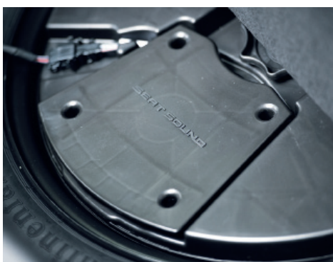
Modulul de sunet al sistemului audio este poziționat ingenios în interiorul roții de rezervă.
